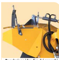
Regolazione idraulica dei coperchi Hydraulic regulation of the side covers
